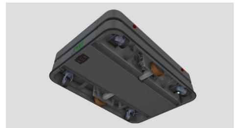
Figura 2. Módulo em formato de bancada que poderá ser acoplado ao robô móvel.
