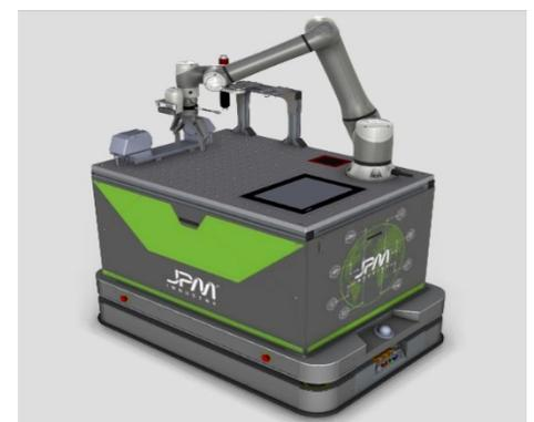
Figura 3. Projeto completo com o módulo instalado por cima do robô movel.
