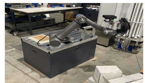
Figura 2. Bancada para preparação da demonstração da montagem colaborativa e do machine tending. Robô móvel com braço robótico colaborativo.
