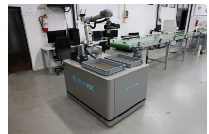
Figura 3. Protótipo de manipulador móvel utilizada para validação e teste dos diferentes algoritmos desenvolvidos
