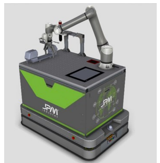
Figura 2. Projeto completo com o módulo instalado por cima do robô movel, contendo um braço robótico colaborativo TM14 (Soluções de robótica móvel para logística interna).
